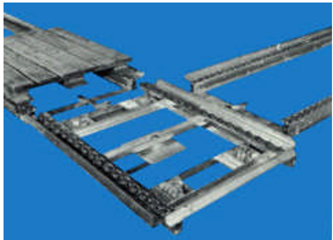
Leichtere Lasten sind mit dem Drehtisch in eine andere Richtung zu fördern. Die Drehung erfolgt von hand.
