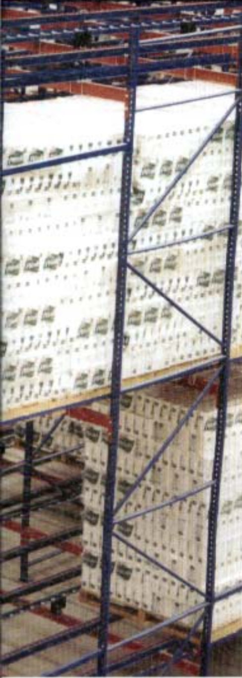
Almacén de flujo dinámico para almacenar producto terminado con capacidad para 882 posiciones tarima de la empresa, Kimberley Clark en la planta Sepamisa en Morelia, Mich.
